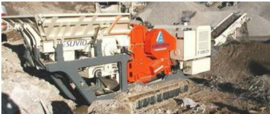
Fig. 2: Frantoio semovente a mascelle VESUVIO Super F1000 CV
