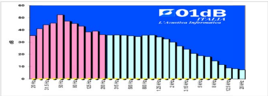
Verifica presenza componenti Tonalì:
