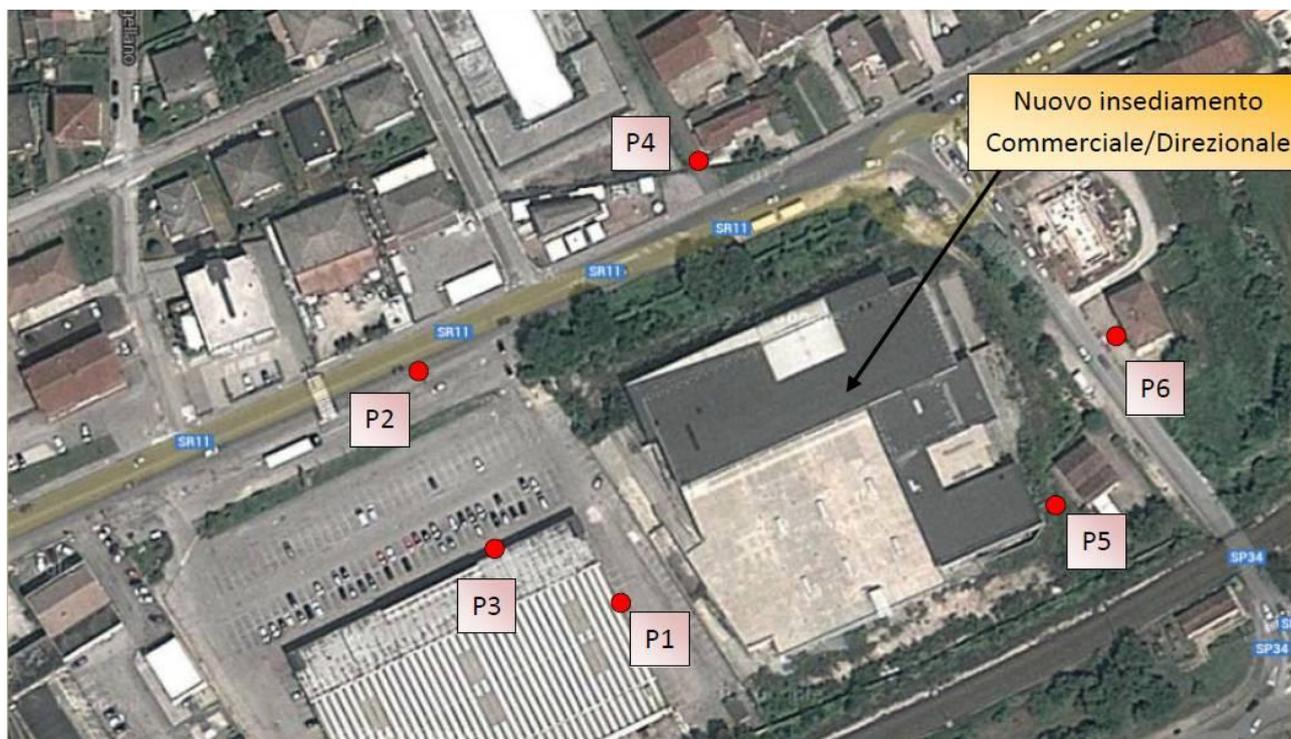
*Planimetria con indicazione dei punti di misurazione fonometrica (punti P)*
