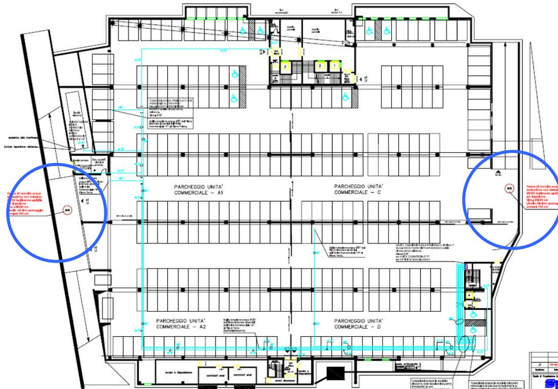
*Posizionamento delle vasche di raccolta delle acque e dei vani contenenti le pompe nel piano interrato*
