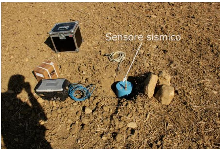
**Fig. 7 – Particolare di installazione di sensore sismico**
