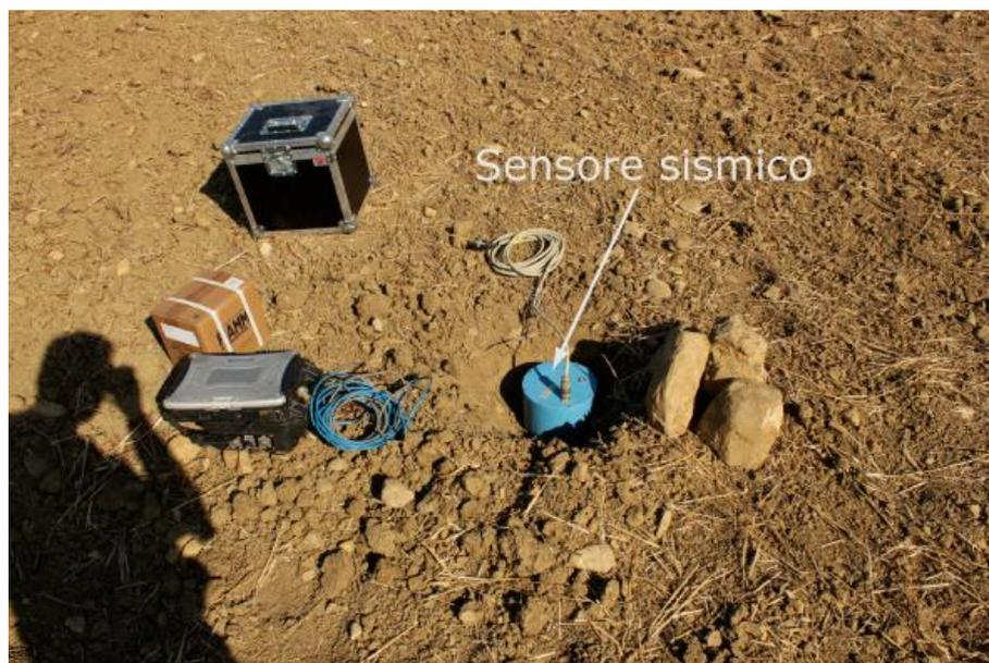
**Fig. 36 – Particolare di installazione di sensore sismico**
