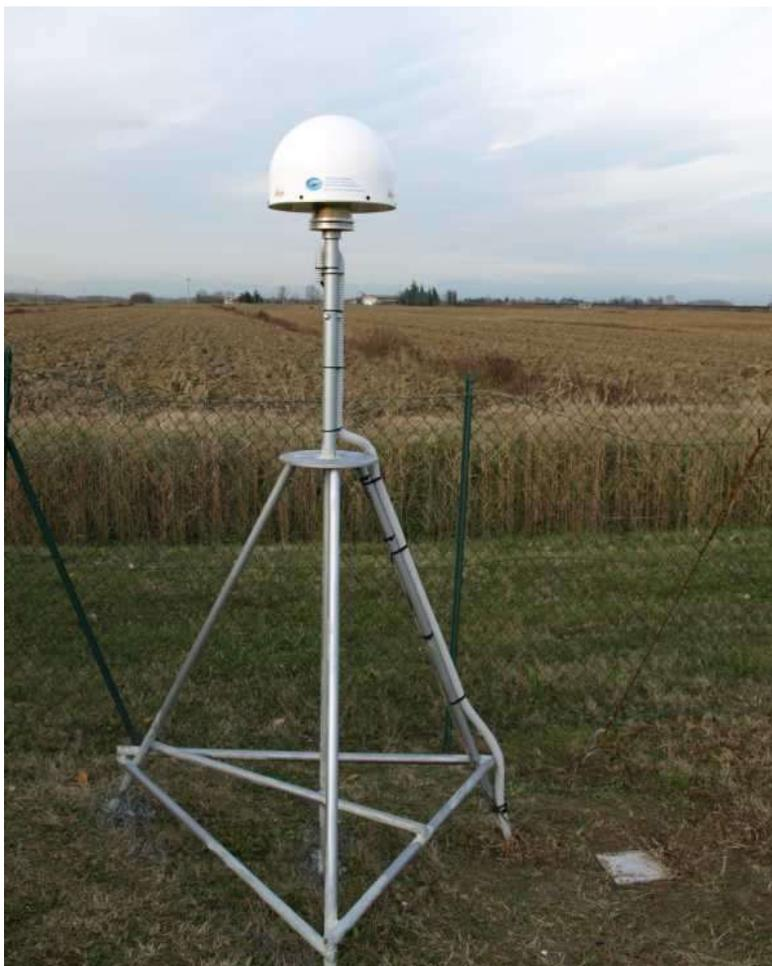
**Fig. 17 - Monumento per l'antenna GNSS proposto in questo progetto nel caso di terreni poco consolidati. L'immagine raffigura il monumento della stazione PAZO della rete FreDNet.**
