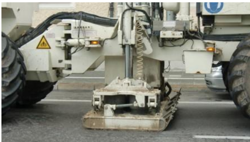
Mezzo Vibroseis adeguato per il rilievo sismico in esame
