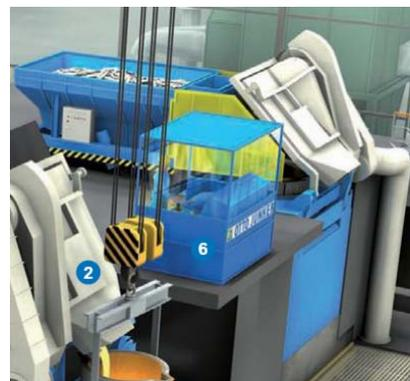
**Figura 5 : Carico materie prime nel forno**
