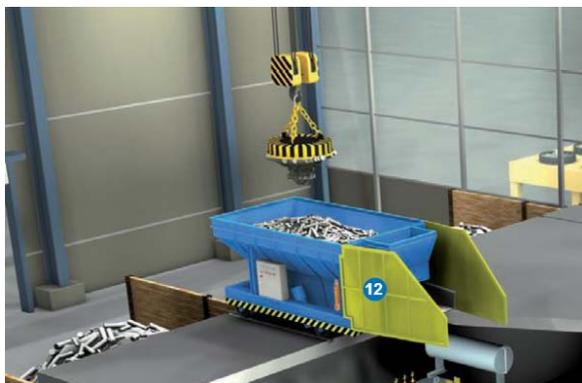
**Figura 6 : Caricamento carro con magnete**
