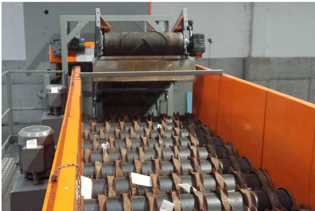
Foto 4. Vaglio a dischi della tipologia prevista nell'impianto in progetto.
