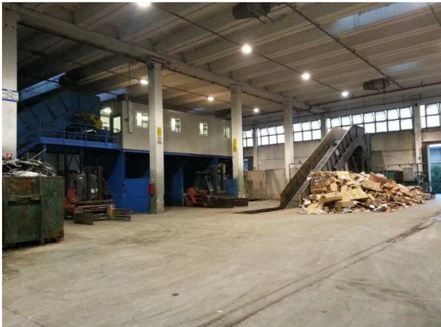
Foto 3. Panoramica dell'impianto: sullo sfondo nastro trasportatore pressa imballatrice.
