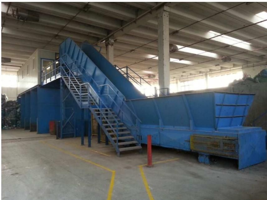
Foto 1. Linea di selezione e riduzione volumetrica.
