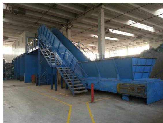
Linea di selezione e riduzione volumetrica.
