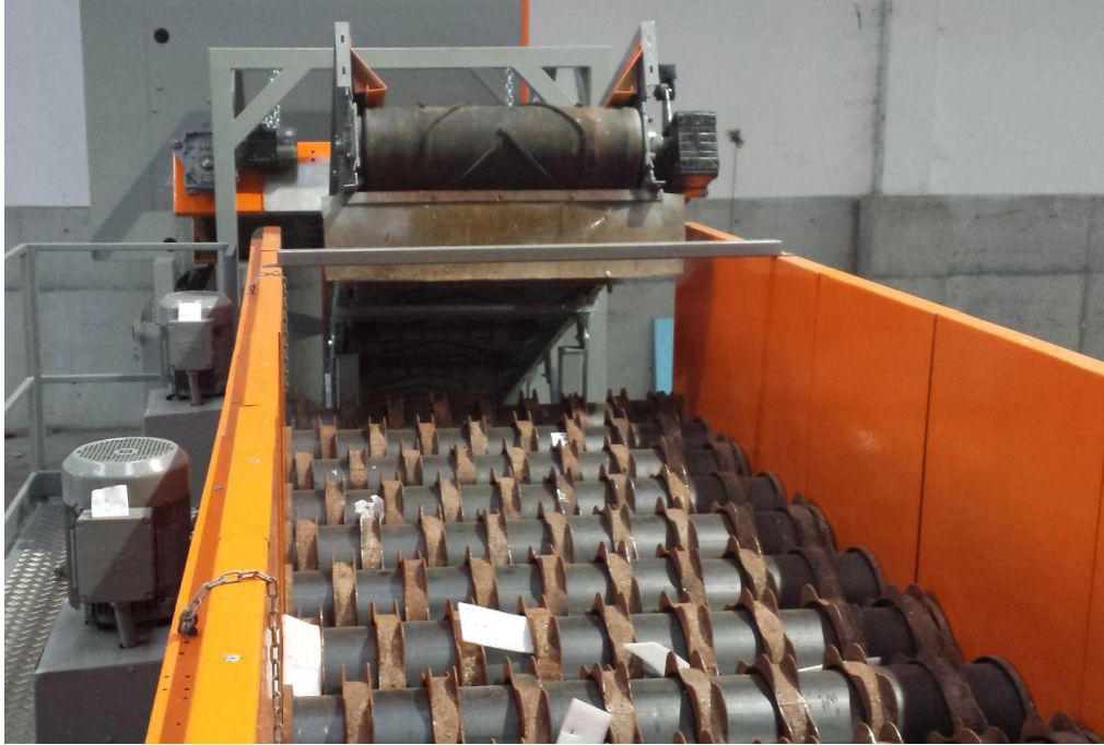
Foto 2. Vaglio a dischi della tipologia prevista nell'impianto in progetto.
