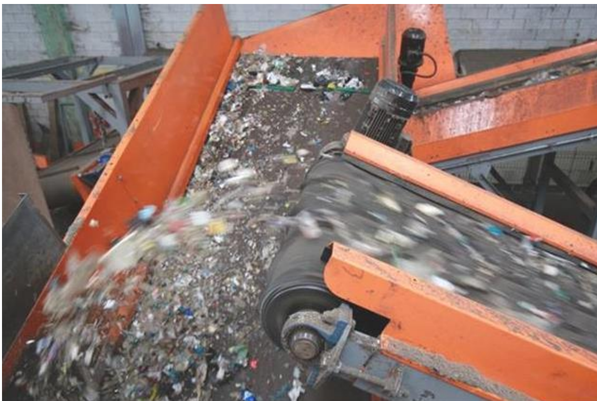
Foto 3. Materiale leggero e voluminoso in uscita dalla cabina aeraulica ed inviato al raffinatore.
