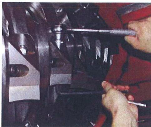
*Lame intercambiabili e rapidamente sostituibili*
