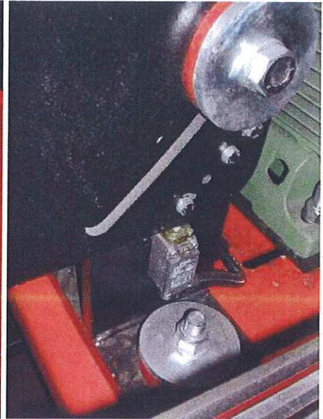
Sistema di protezione della trasmissione a spine di rottura
