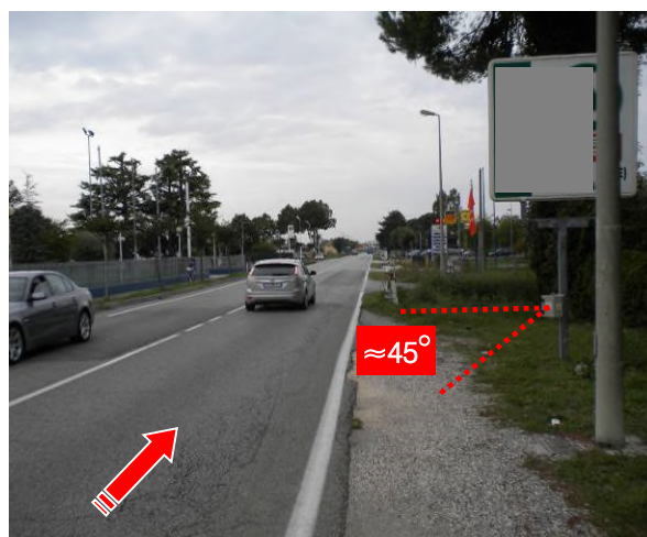
Figura 5.2 – Angolo di installazione dei radar rispetto alla direzione di marcia
