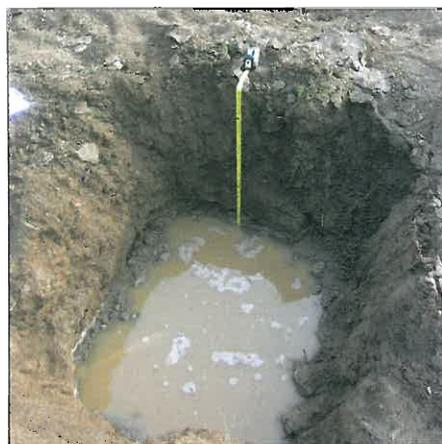
La prova eseguita secondo la metodologia A.G.I. (Raccomandazioni sulla programmazione ed esecuzione delle Indagini Geotecniche - 1977) ha permesso di valutare il coefficiente K indicativo di permeabilità verticale dei primi metri del substrato alluvionale, pari a:
