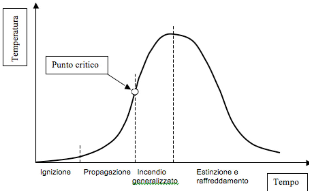
Fig. 1. Diagramma temperatura/tempo dell'incendio civile.
