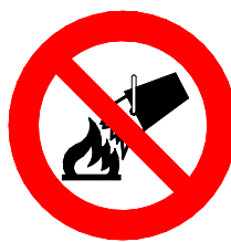
DIVIETO DI USARE ACQUA
