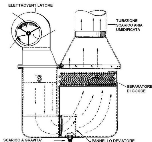
Con le modifiche in programma dall'azienda verranno installati 2 nuovi evaporatori atmosferici a servizio del trattamento di ramatura nella linea 2 e nella linea 4. I dispositivi avranno caratteristiche tecnico-costruttive e funzionamento identici a quelli dell'evaporatore attualmente presente presso la linea 1.
