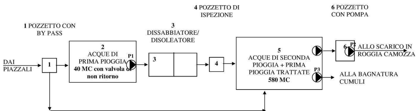
Figura 48: Schema a blocchi del ciclo di trattamento delle acque.
