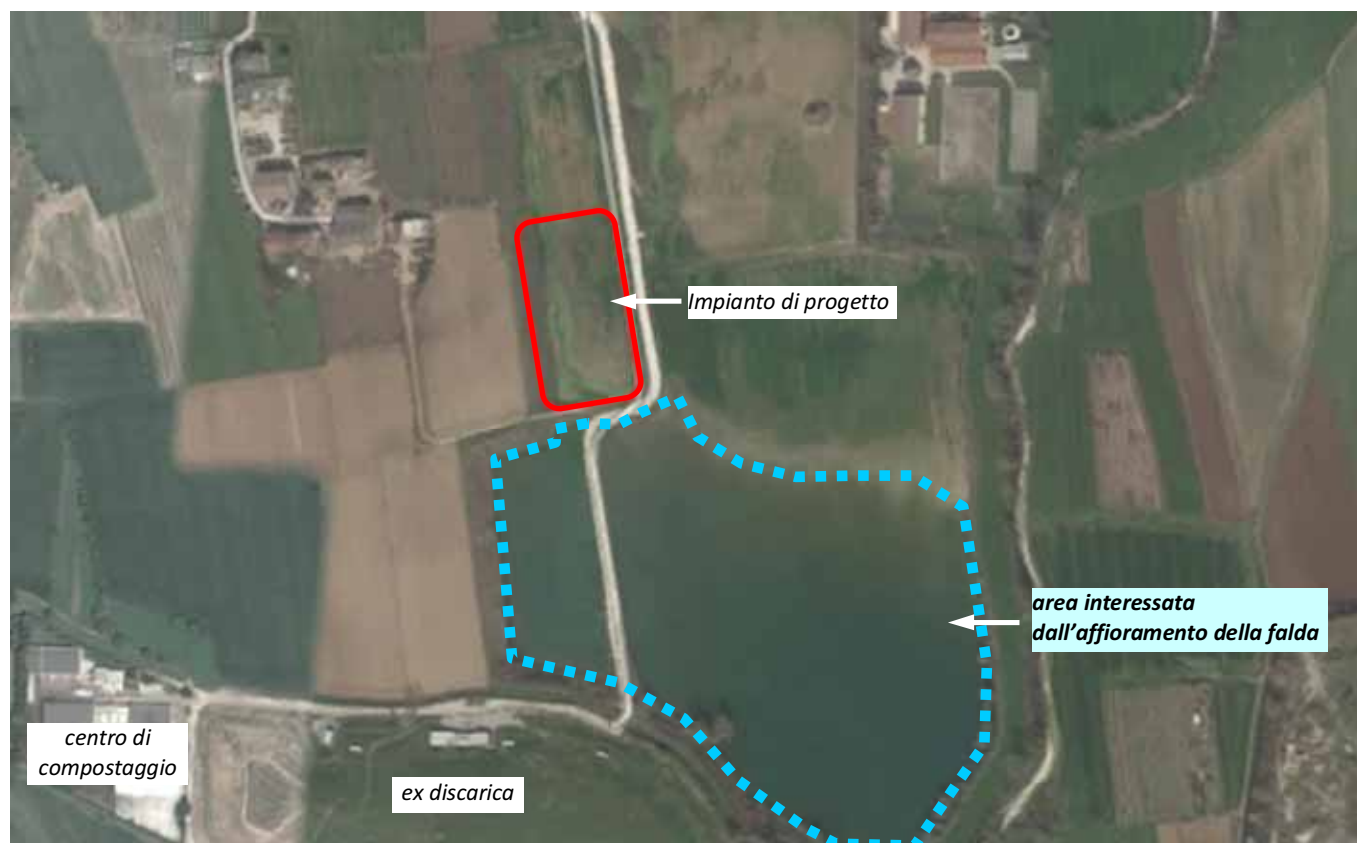
Figura 62: Area interessata dall'affioramento della falda (evento di piena del febbraio 2014).
