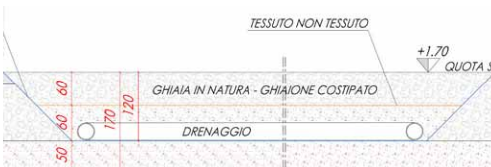
Figura 44: particolare dell'area impermeabilizzata per lo stoccaggio dei materiali in uscita dal ciclo di trattamento.
