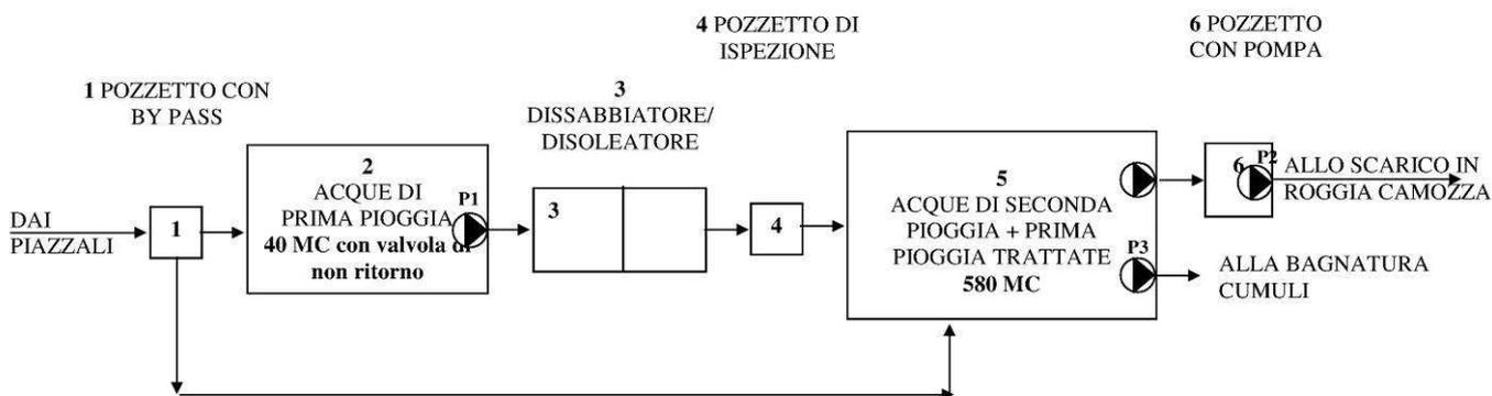
Per quanto riguarda le acque temporaneamente raccolte all'interno della vasca di accumulo di 580 mc, il progetto prevede, in una fase iniziale, l'analisi della salinità (conducibilità e anioni cloruri e solfati) di queste, inizialmente con scansione trimestrale e successivamente ogni 12.
