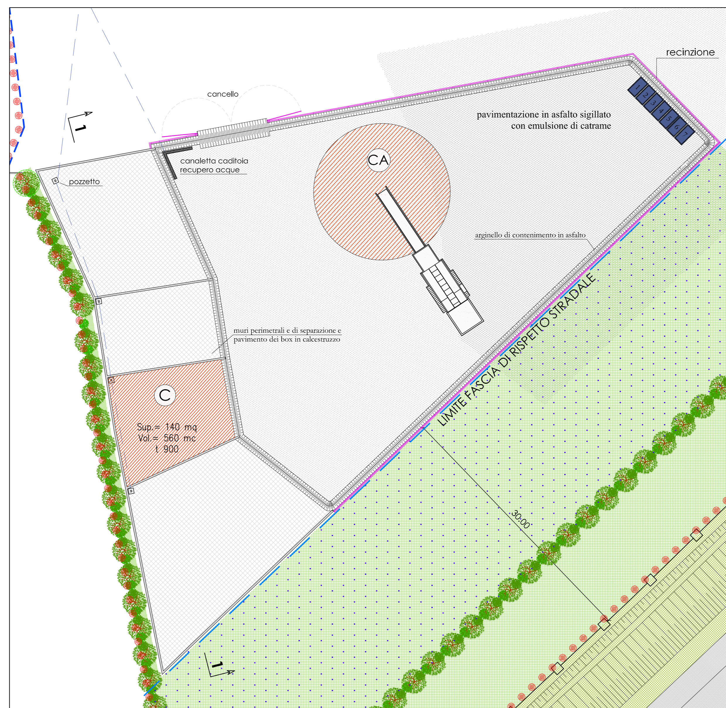
LAYOUT LINEA TRATTAMENTO C - FRANTUMAZIONE MISCELA BITUMINOSA
