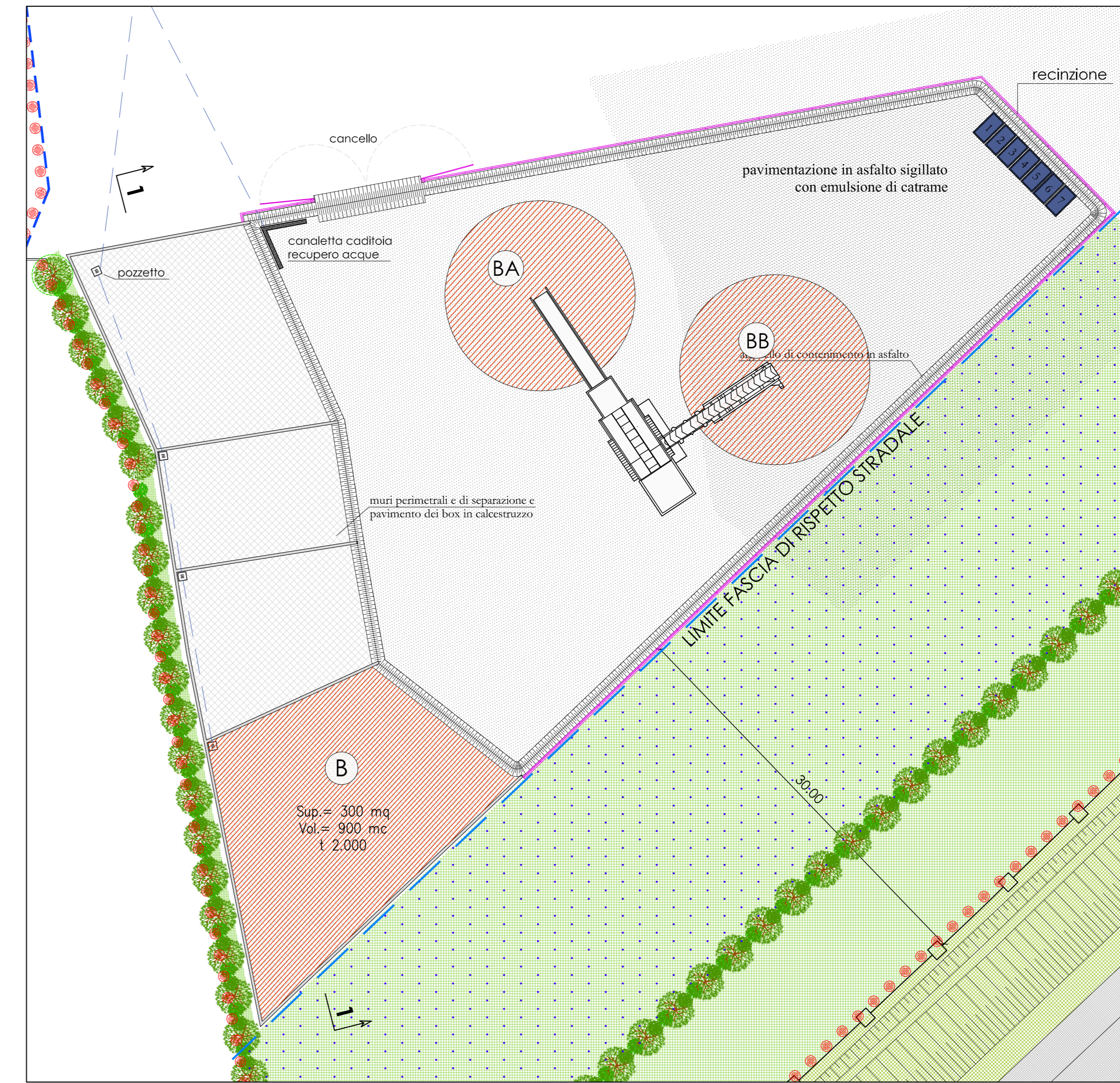
LAYOUT LINEA TRATTAMENTO B - FRANTUMAZIONE E/O VAGLIATURA TERRE E ROCCE (a matrice ghiaiosa)
