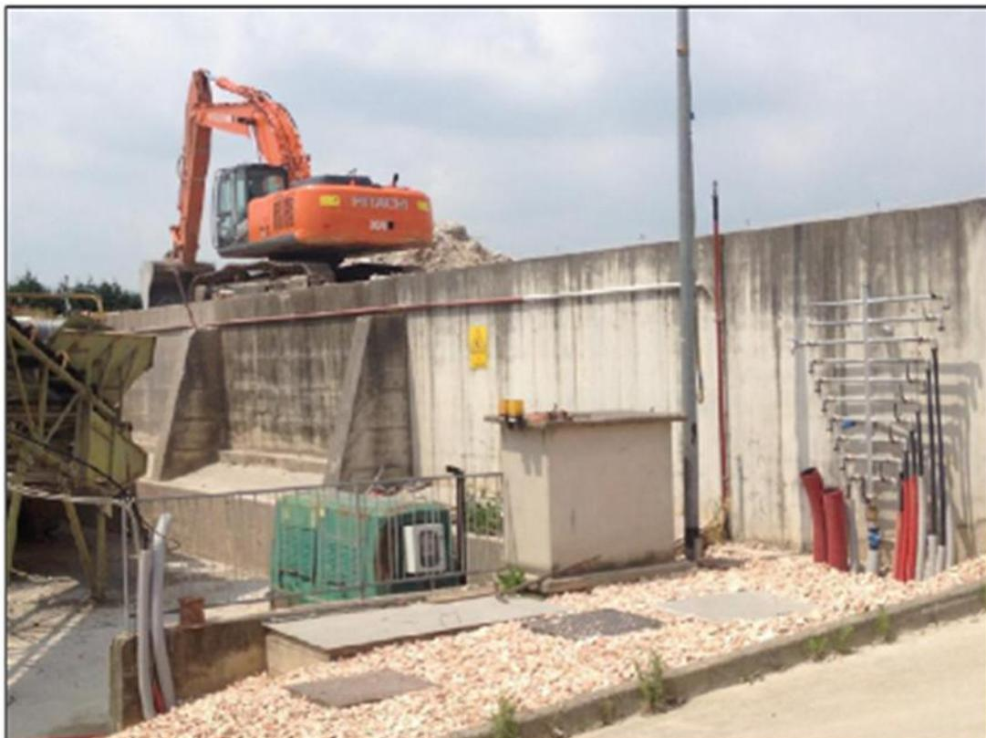
Foto n.2: Escavatore in fase di carico frantoio. Si vede il muro posto dietro il frantoio
