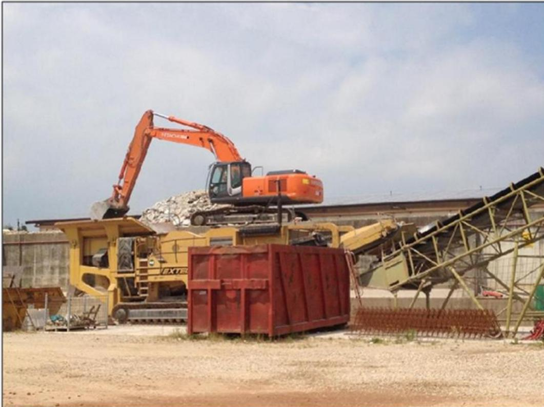
Foto n.1: Frantoio EXTEC ed escavatore cingolato al lavoro (in fase di carico materiale in tramoggia) – già autorizzato
