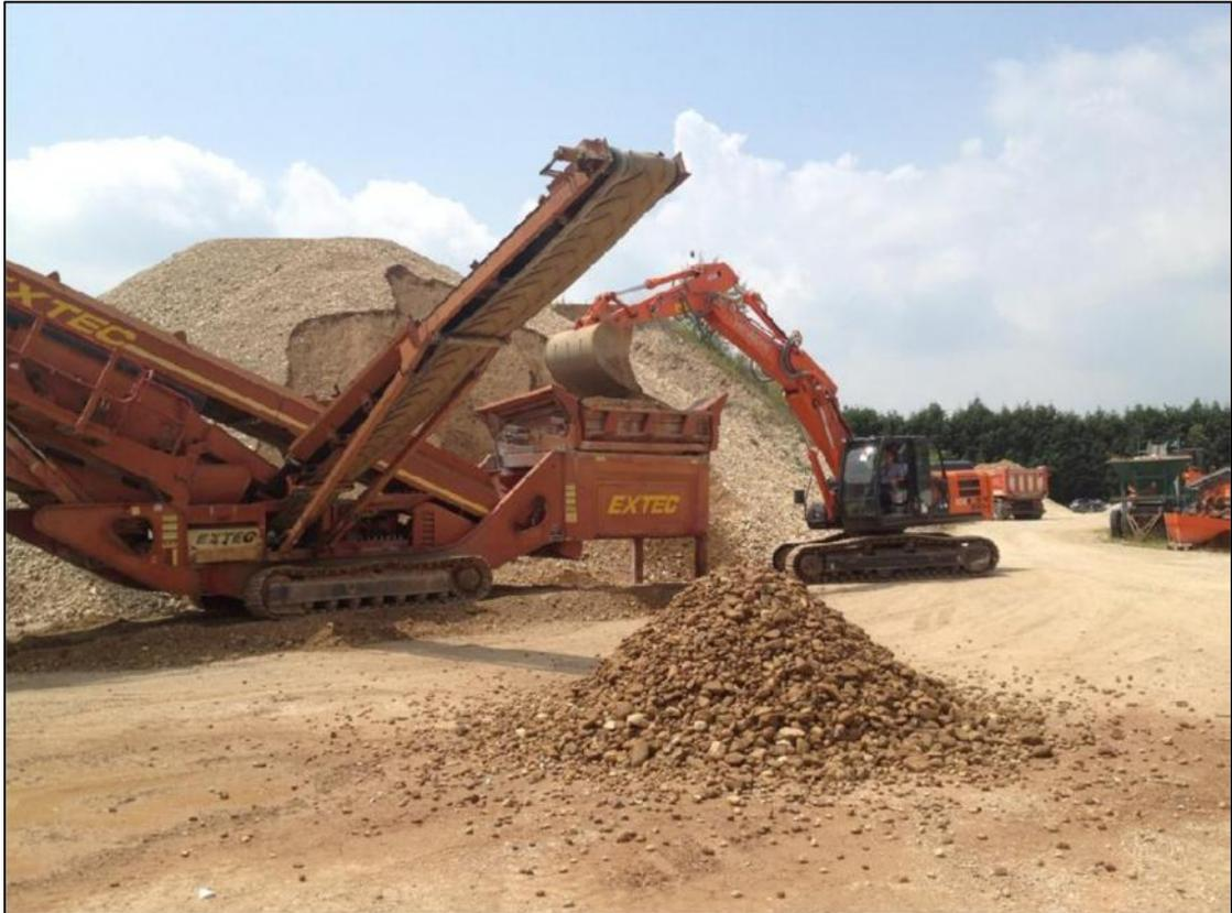
Foto n.3: Vaglio EXTEC ed escavatore - Simulazione attività con materiale naturale
