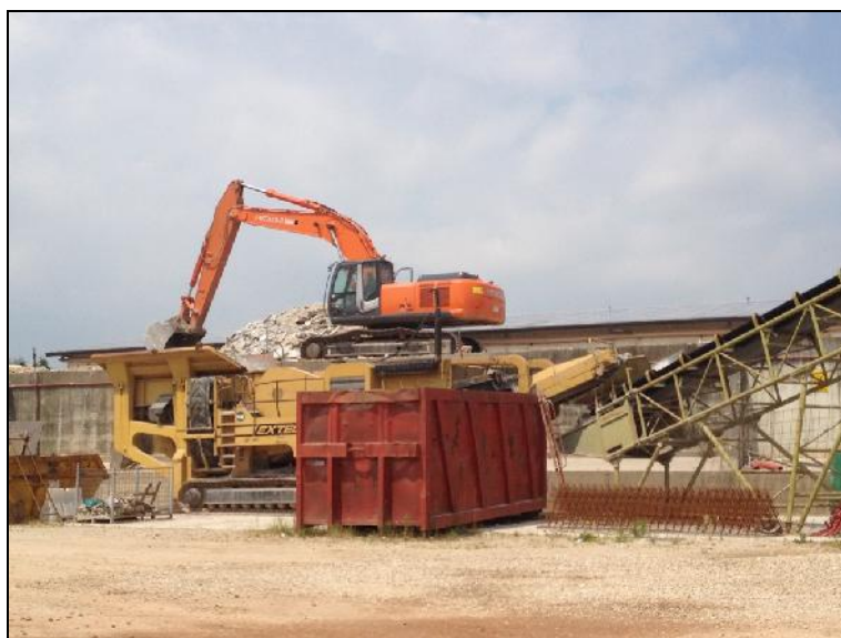
Foto n.1: Frantoio ed escavatore in fase di frantumazione (assetto attuale che non verrà modificato)
