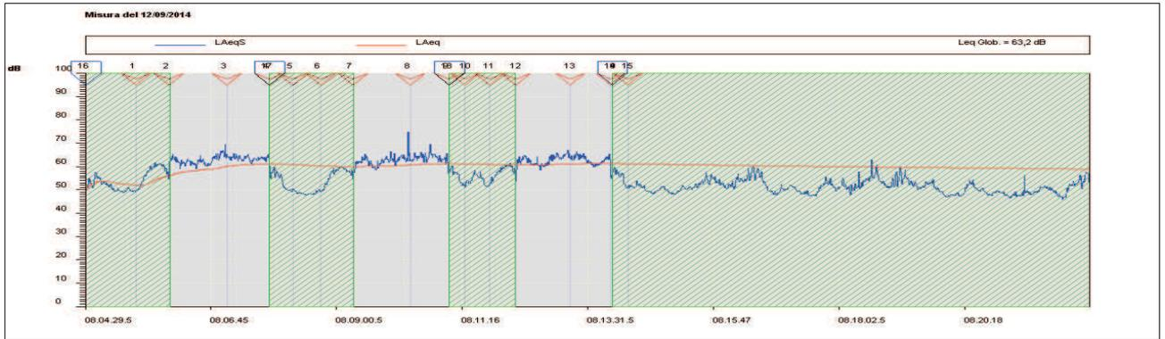
Grafico 2.3: ambientale scarrabile solo movimentazione cassone (tolte maschere) Leq=63,2 dBA - L<sub>95</sub>=60,1 dBA - L<sub>90</sub>=60,7 dBA - L<sub>70</sub>=62,3 dBA
