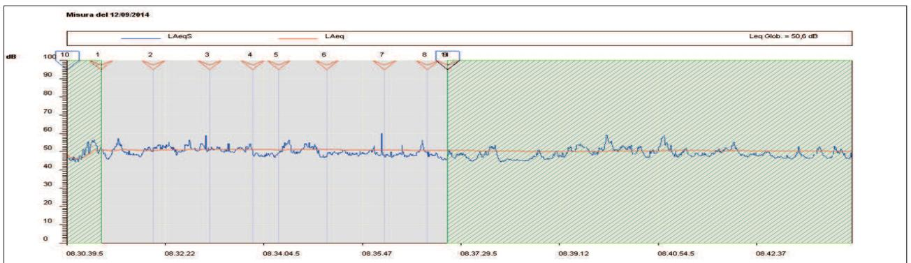
Grafico 3.2: ambientale scarrabile (tolta maschera) Leq=50,6 dBA -  $L_{95}=47,1$  dBA -  $L_{90}=47,6$  dBA -  $L_{70}=48,8$  dBA
