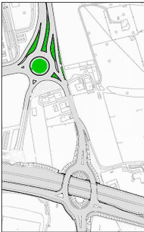
Figura 3.3 Collegamento della rotatoria al nuovo tracciato della SP 111 complanare alla Pedemontana
