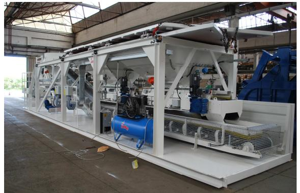
**N.2 Coni** di estrazione inerti con lamierati spessore mm.4 aventi opportuni rinforzi Sp.10 mm. nell'intera zona di scarico aggregati, N.1 piastra vibrante indipendente ed intercambiabile, collegata a vibratore elettrico esterno da kg. 200.
