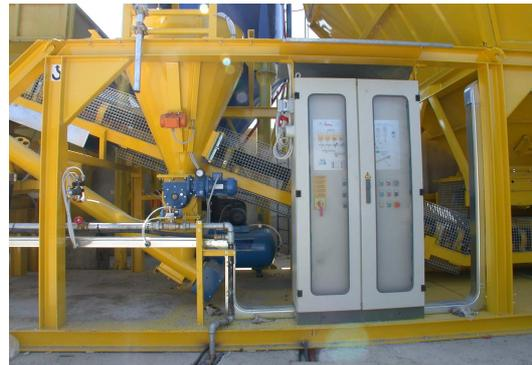
Il grado di protezione del quadro sarà IP54 adatto per installazione in cabine di comando ottenuto con guarnizioni in gomma antinvecchiamento.
