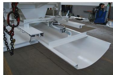
Mixer completo di coperture antinfortunistiche con blocco ad estrazione di chiave, boccaporti di ispezione e impianto elettrico a bordo macchina.
