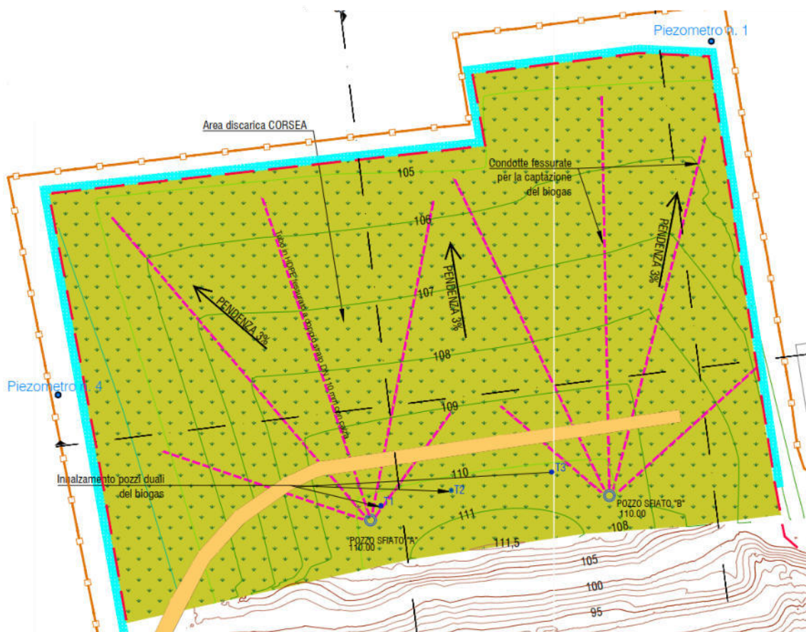
Figura 42 – Stato di progetto dell'impiantistica della discarica CO.RSEA. in località Quartieri
