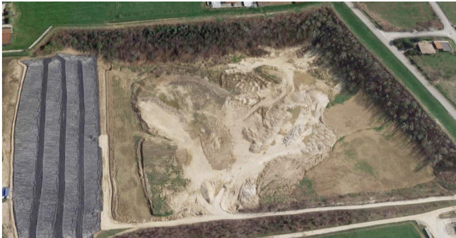
Figura 34 – Panoramica della sistemazione morfologica del fondo della cava SIG, e della scarpata della discarica CO.RSEA messa in sicurezza con teli .
