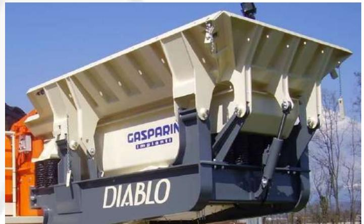
I cilindri delle pareti ribaltabili sono alloggiati all'interno del telaio in posizione protetta.
