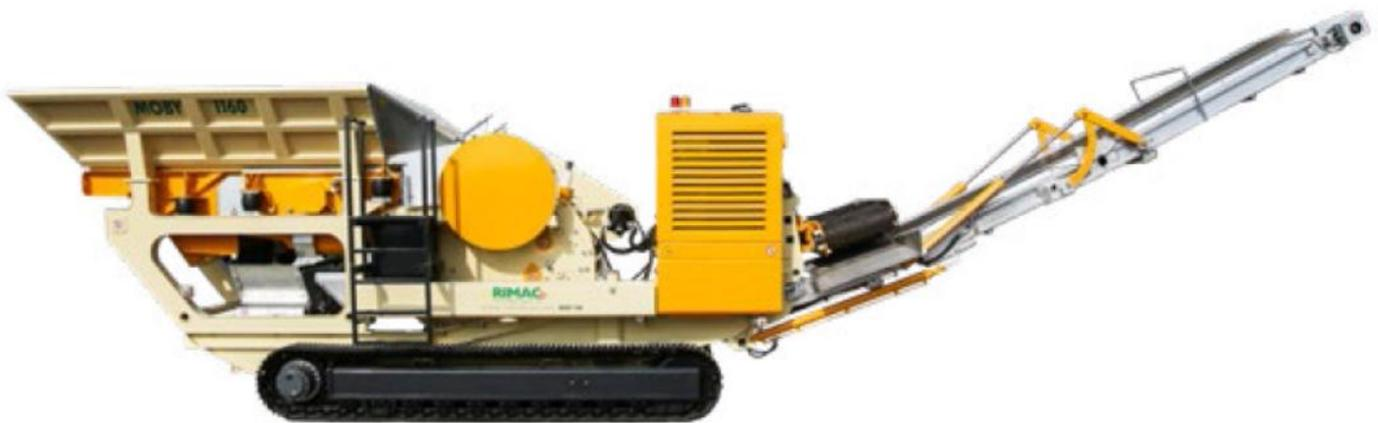
Il frantoio comprende un tritatore (potenza installata 129 kW) ed un deferizzatore magnetico (1.5 kW). Si riportano nella figura seguente le dimensioni del macchinario.
