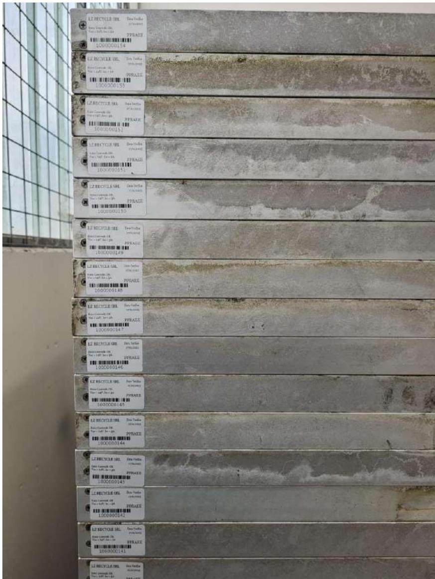
**Fotografie 7, 8 – Etichette create con il gestionale per la conduzione dei test ed applicate sui pannelli ricondizionati.**
