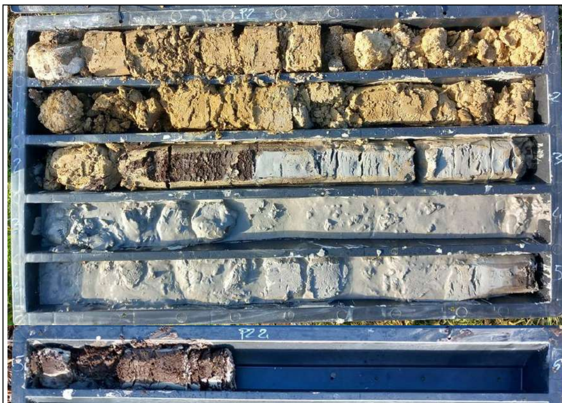
Sondaggio Ambientale PZ2 - Contenuto cassetta catalogatrice (0,00 – 5,40 m)
