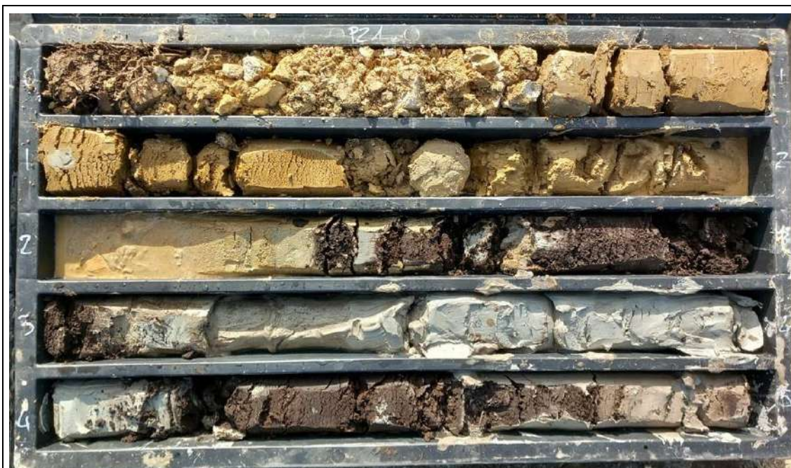
Sondaggio Ambientale PZ1 - Contenuto cassetta catalogatrice (0,00 – 5,00 m)
