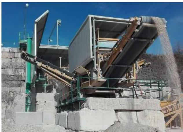
**FOTO 2 – Schermatura antirumore sul lato ovest e superiore alla zona di selezione granulometrica**
