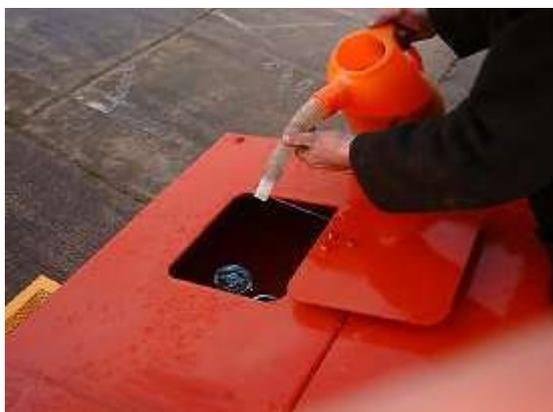
3:- Controllare il livello del carburante ed eseguire un rabbocco se necessario.
