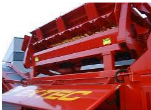
14:- Vibrogriglia appoggiata sulle gambe di sostegno. NOTA: - Le gambe di sostegno sono dotate di diversi fori per i diversi angoli della griglia.
