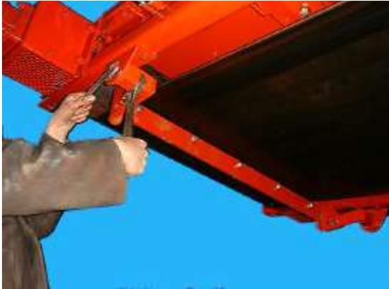
*Allentare la vite all'esterno del raschiatore rosta. Usare la chiave regolabile per girare il rosta forzando così il raschiatore verso il nastro. Stringere nuovamente la vite esterna esercitando, allo stesso tempo, pressione sul rosta per bloccare il raschiatore nella posizione desiderata. Seguire la stessa procedura per il raschiatore del trasportatore della tramoggia.*
