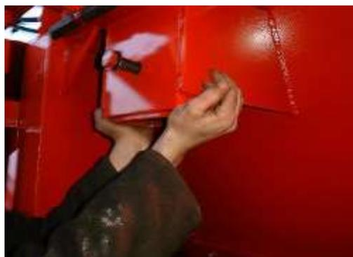
12:- Sollevare le gambe di sostegno della griglia e fermarle con la vite apposita per fissare l'angolo della griglia.
