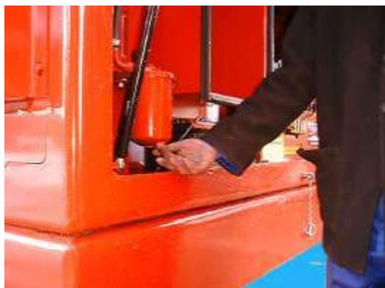
4:- Spurgare il pozzetto dell'acqua del motore diesel.
