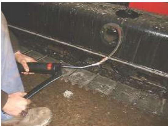
*2:- Inserire il tubo di lubrificazione fornito & lubrificare i cingoli secondo necessità - utilizzare grasso di tipo EP2.*
