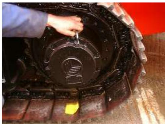
2:- Togliere il tappo di riempimento dell'olio e rabboccare usando olio di tipo SAE 30W. Quando l'olio inizia a gocciolare fuori dal tappo di livello, ciò significa che il livello dell'olio è sufficiente.
