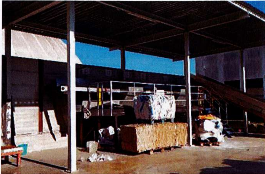
Figura 10. Nastro trasportatore per la selezione manuale dei rifiuti
