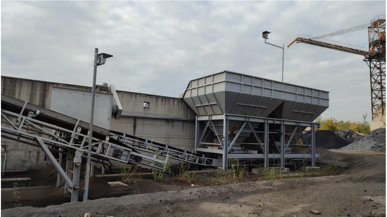
Foto 4 – Tramoggia di carico del granulato dall'impianto di recupero dell' Area A al forno rotante essiccatore con i nastri di carico
