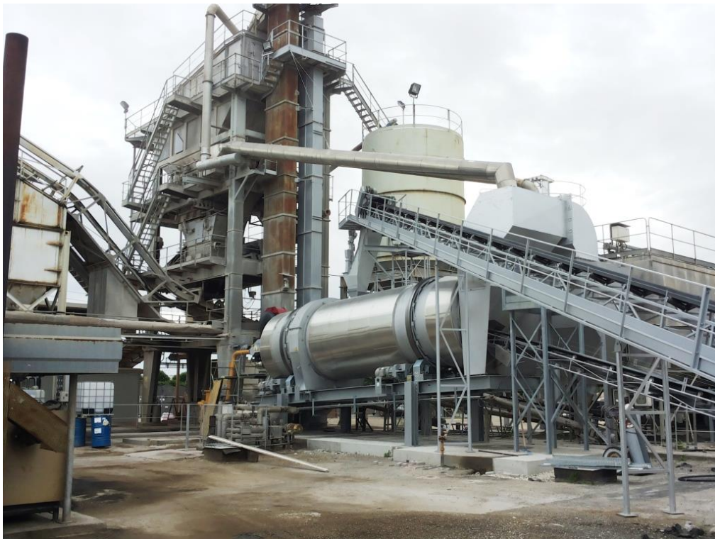
Foto 5 – Vista del forno essiccatore e delle torri dell'impianto di bitumaggio dove si produce il conglomerato bituminoso della B TECH srl (dal collaudo del 2018)
