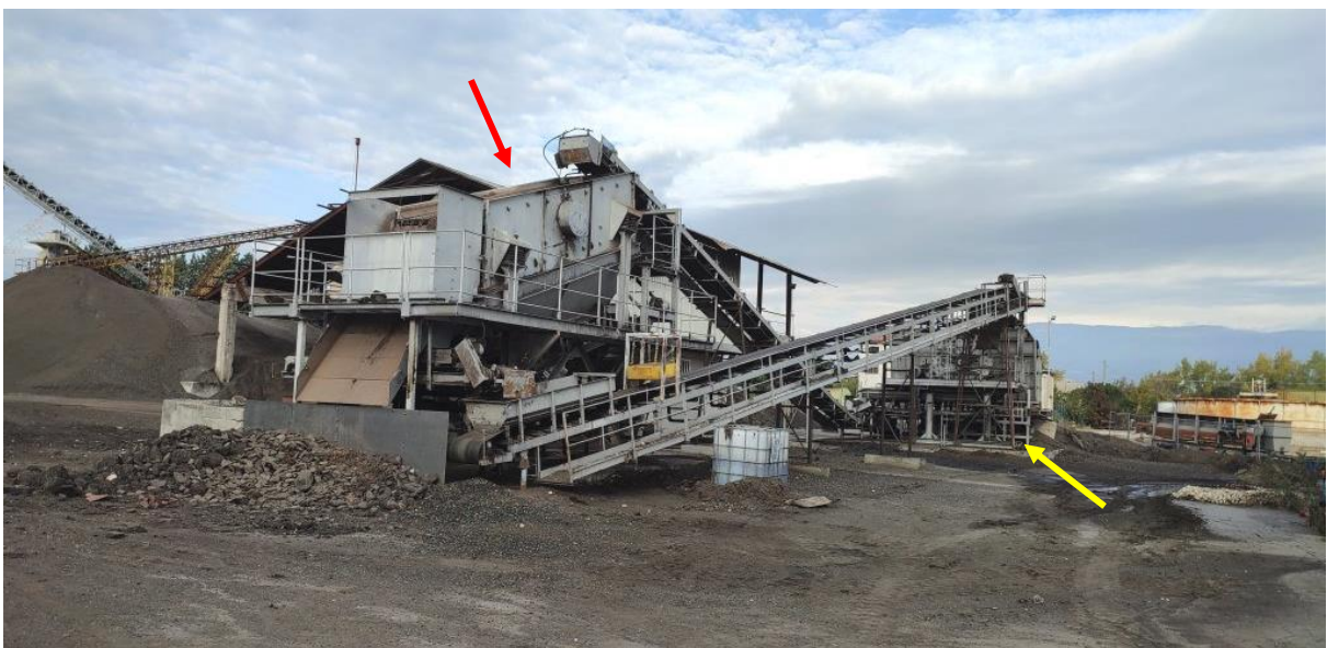
Foto 3 - Vista del mulino (freccia gialla) e del vaglio vibrante (freccia rossa) del fresato in Area A
