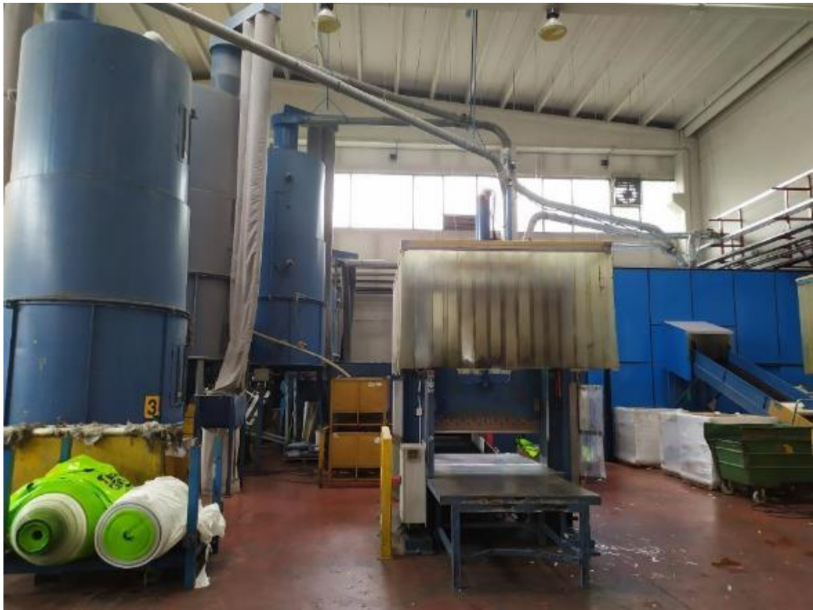
Foto 20. Taglierina (al centro), mulino di macinazione (sullo sfondo a destra) e silos (a sinistra)
