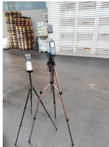
Foto n. 10 - 11 : fase di calibrazione ad inizio e fine delle misure
