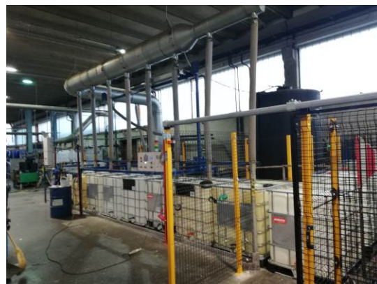
Foto n.4 e n.5 : Fase di lavaggio dei fusti industriali
