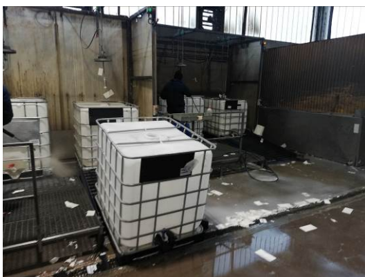
Foto n.4 e n.5 : Fase di lavaggio dei fusti industriali
