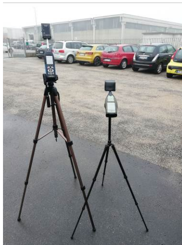
Foto n. 10 - 11 : fase di calibrazione ad inizio e fine delle misure
