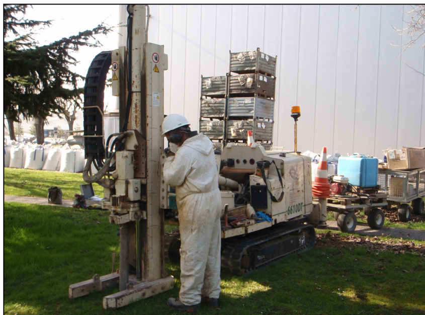
Esecuzione sondaggio con Geoprobe
