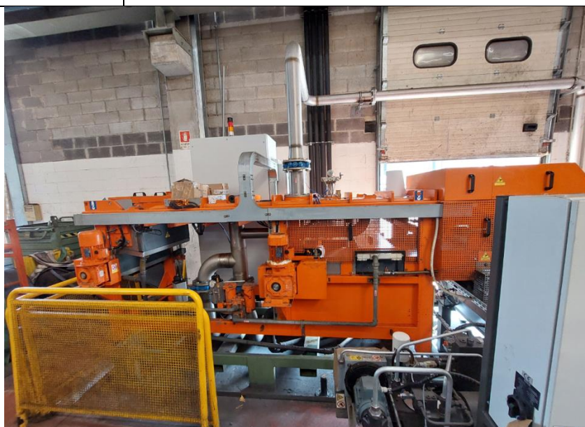
Fig. 4 - Dispositivo per la filtrazione in pressione della emulsione oleosa e il compattamento in "bricchetti" metallici dei residui di lavorazione.
