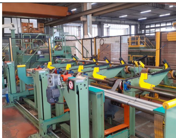
Fig. 2 - Sgrossatrici, con lavorazioni in carter.
