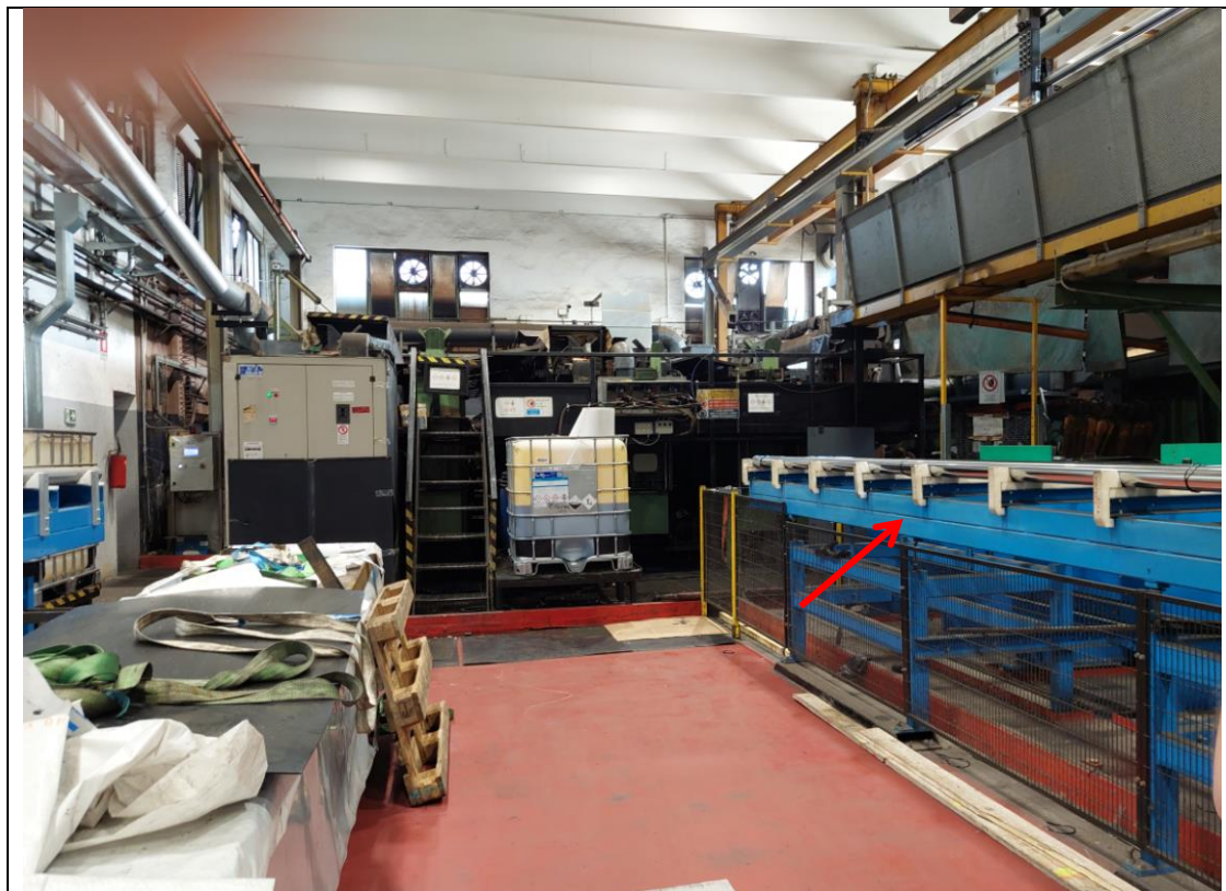
Fig. 15 – Veduta della parte storica delle linee di trattamento galvanico; la rulliera costituisce l'uscita dall'impianto delle linee 2C di trattamento in continuo.
