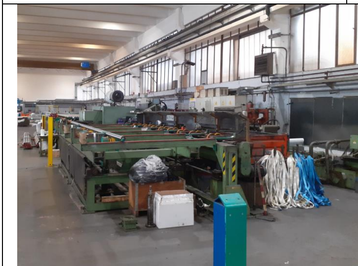
Fig. 11 – Lucidatura (o Pulitura) del semilavorato cromato mediante nastri (in emulsione) e spazzole (a secco) con ASPIROFILTER e LOSMA in Capannone 2 (3 macchine)
