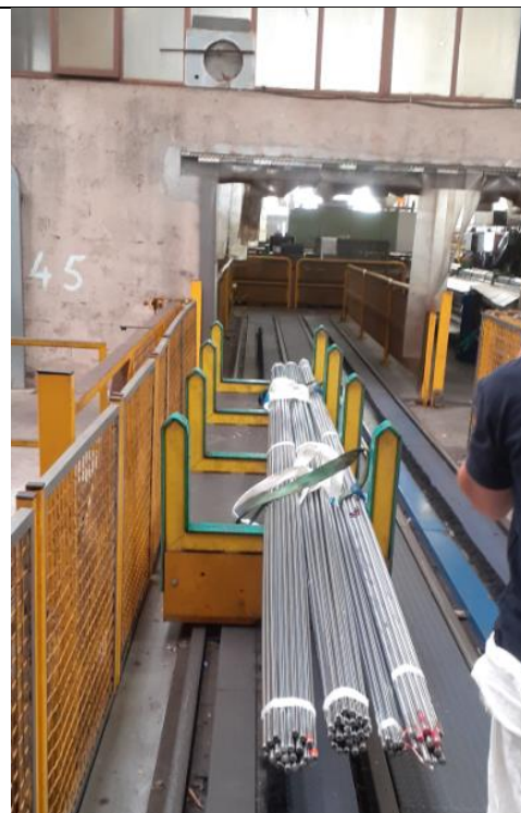
Fig. 8 – Traslazione interna dal capannone 1 al capannone 2 dei semilavorati su carrellini automatici.
