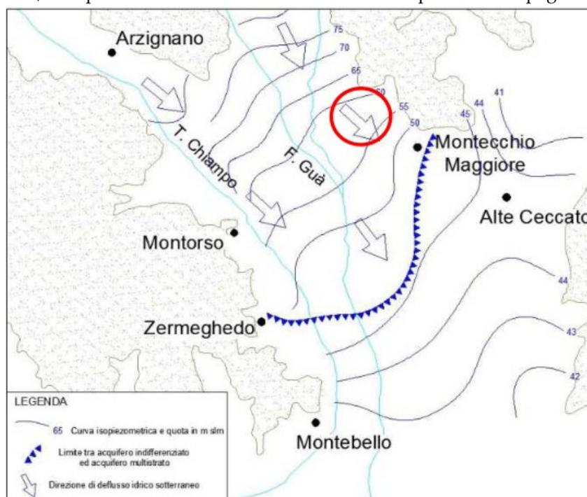
La direzione del deflusso sotterraneo è mediamente NW-SE, sviluppandosi parallelamente all'asse vallivo; il gradiente idraulico è variabile, generalmente compreso tra lo 0,5 e lo 0,8% nella zona in esame.
