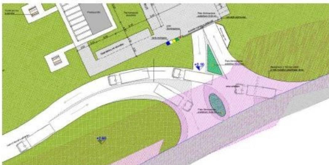
Planimetria di progetto accesso carraio lungo la SP 33
