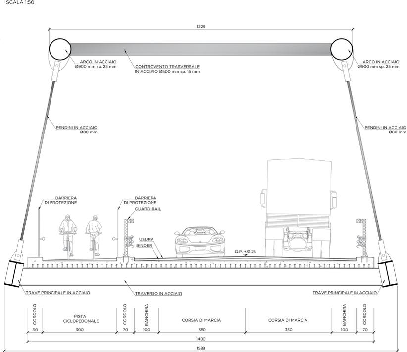
**SEZIONE TIPO C-C DI PROGETTO IN APPROCCIO AL PONTE**
